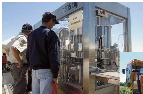
La toute nouvelle chaîne d'embouteillage mobile de la cuma de la Meusnes. Prévision de coût : 0,02 €/bouteille.
