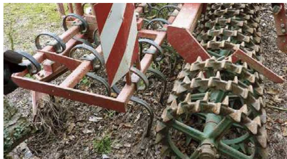
Les dents vibrantes et le rouleau Kroskill montés à l'avant et à l'arrière du tracteur.
