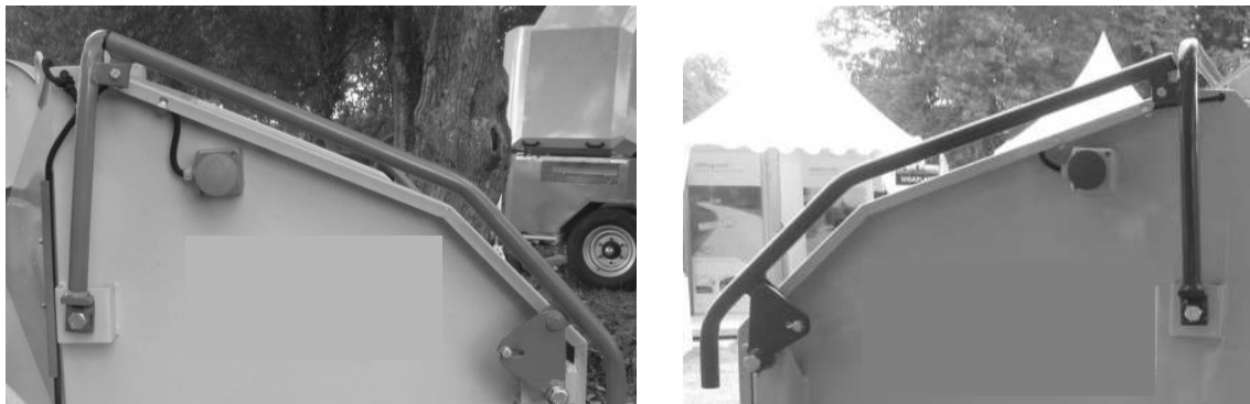
Figure 24 - Arrêts d'urgence présents de chaque côté de la goulotte
