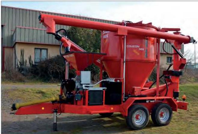
**APLATISSEUR ET BROYEUR À CÉRÉALES MOBILE COUZON-MIX**
