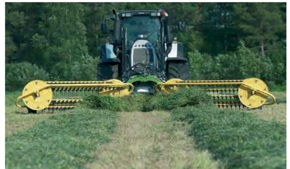
L'andaineur Elho ne traîne pas le fourrage sur le sol mais le propulse diagonalement vers le haut. Résultat : pas d'impureté, ni de pierre. A vérifier lors des démonstrations.
