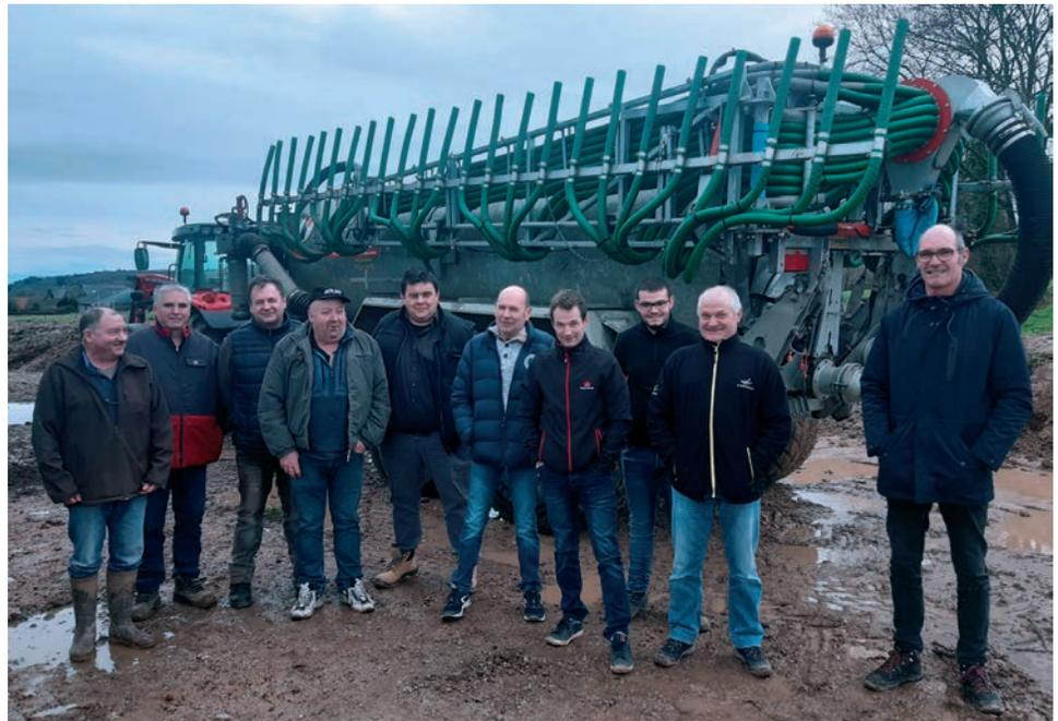
La tonne de la cuma basée à Plestin-les-Grèves est équipée d'un bras de pompage avec turbine pour pomper dans un cône. L'essieu est un boggye avec un suiveur et des pneumatiques en 650/65R26.5.
