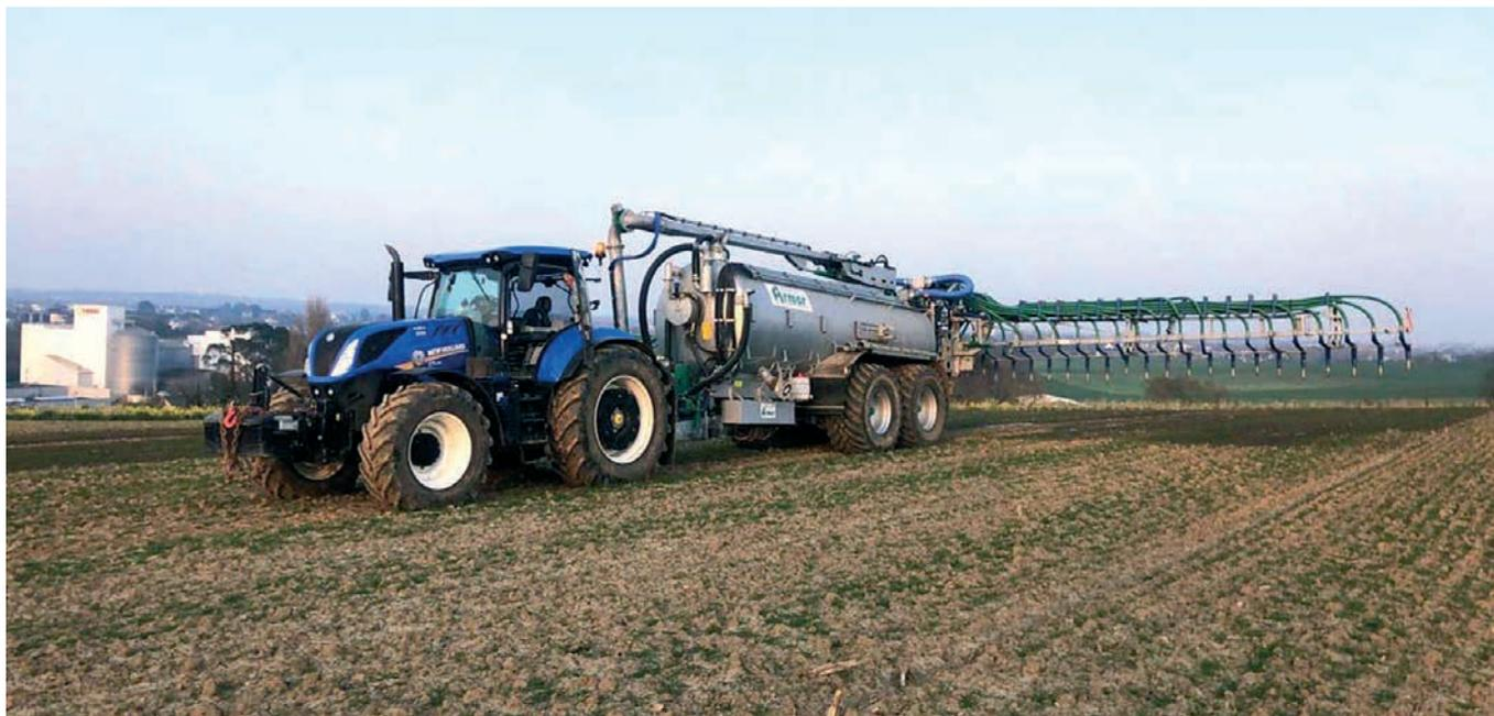
Pour mener la tonne 18 m<sup>3</sup>, le T7 245 est lesté de 350 kg sur chaque roue arrière, en plus de la masse avant de 1,3 t.
