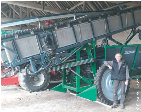
Une écimeuse classique coupe uniquement les têtes des adventices. L’écimeuse récupératrice dispose de tapis situés derrière la lame qui ramènent au centre les graines jusqu’à un tombereau.
