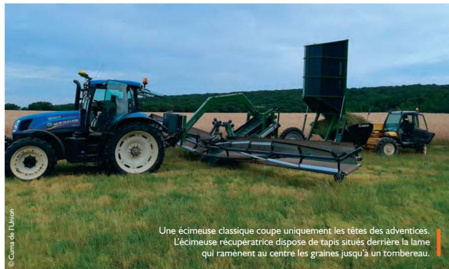
Une écimeuse classique coupe uniquement les têtes des adventices. L'écimeuse récupératrice dispose de tapis situés derrière la lame qui ramènent au centre les graines jusqu'à un tombereau.
