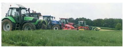
Le gros volet de la démonstration portait sur la partie fauche. Cinq types de faucheuses étaient présentés: faucheuses à disques, combinés de fauche type conditionneuse: à fléaux, à rouleaux (équipée de sabots coupe haute 7 cm,) ainsi qu'une conditionneuse à «peigne». But: évaluer la qualité de fauche et de conditionnage. Pour confirmer l'appréciation visuelle, des prélèvements ont été faits pour déterminer la MS de chaque modalité étudiée (résultats en attente).
