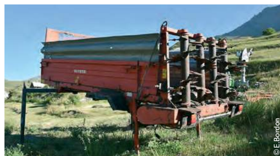
L'épandeur adaptable sur le transporteur articulé. Un outil de petite taille, qui permet de se sentir en sécurité.
