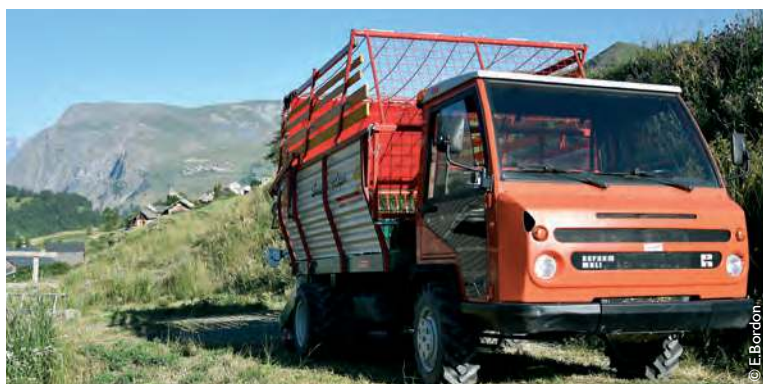
Le transporteur, ici avec l'autochargeuse pour la récolte du foin en vrac dans des terrains en forte pente.
