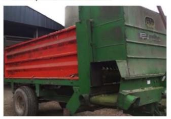
Dans les deux fermes, des modifications ont été apportés aux systèmes de distribution pour pouvoir distribuer le fourrage sans avoir besoin de dételer l'ensileuse. Chez Jérôme, un moteur thermique a été adapté pour entraîner la prise de force de la remorque distributrice. Au GAEC Saint-Lazare, la désileuse a été modifiée pour être animée uniquement par hydraulique.
